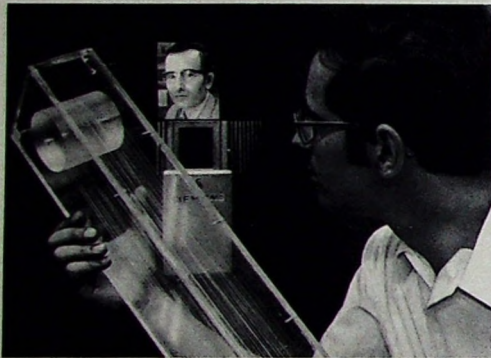
Versuchsaufbau einer Glasfaser-Übertragungsstrecke für Bildfernprechbetrieb
