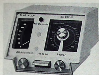
Bild 6 Elektronisches Blutdruck- und Pulsfrequenz-Meßgerät. Rechts die Blutdruckanzeige und links die Pulszahlanzeige (Elag, Köln)
